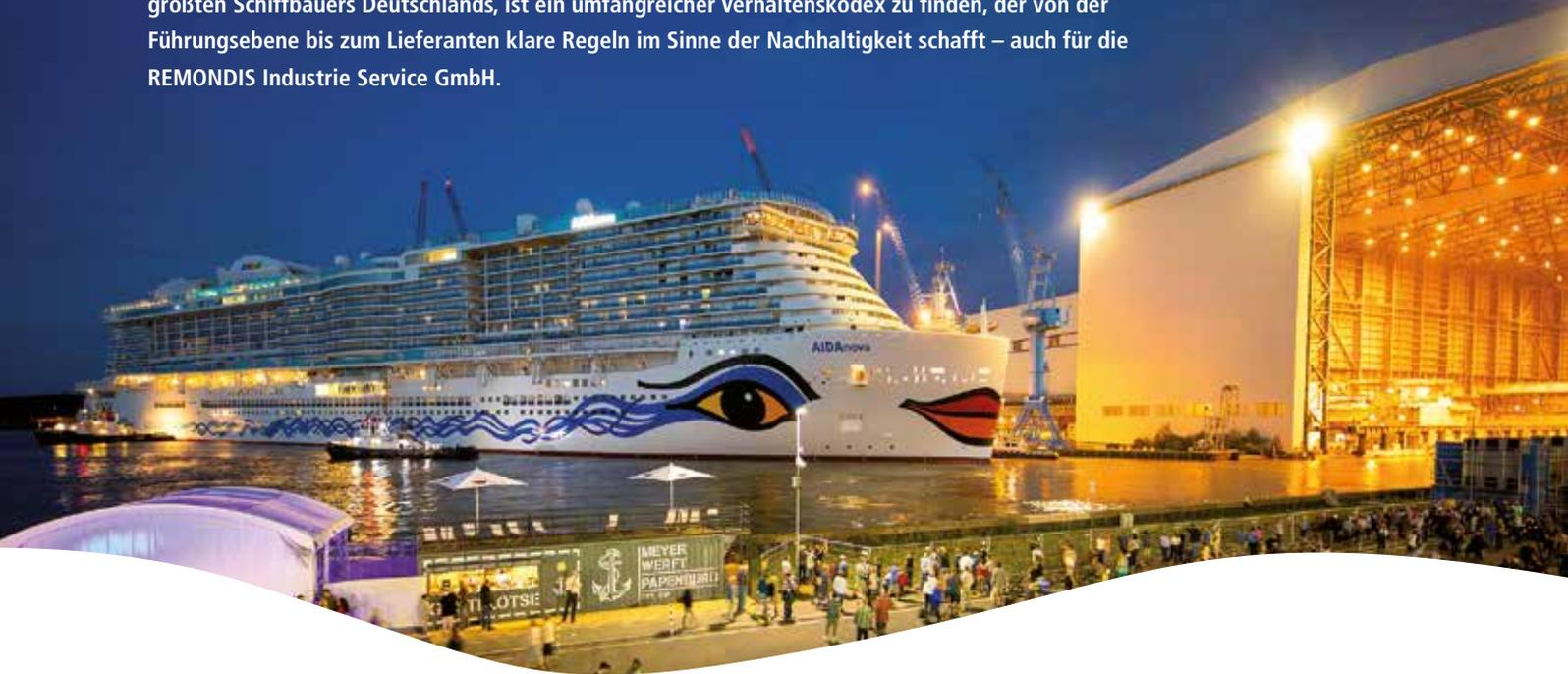
Der Name Meyer Werft steht international für ein ausgewiesenes Know-how im Bau von hochkomplexen Schiffen, insbesondere von Kreuzfahrtschiffen. In Papenburg steht die größte Schiffbauhalle der Welt – sie ist 504 Meter lang und 125 Meter breit. Jedes Schiff, das diese Halle verlässt, wird im Blockbausystem zusammengesetzt. Die Vorfertigung und Zusammensetzung der bis zu 90 einzelnen Blöcke bildet
